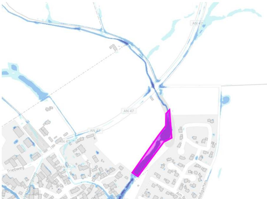
Nach Auswertung der Oberflächenabflüsse (siehe Anlage 1) ergibt sich für den Lastfall HQ100 + 15% (Klimazuschlag) ein notwendiges Rückhaltevolumen von 5.500 m<sup>3</sup>.
